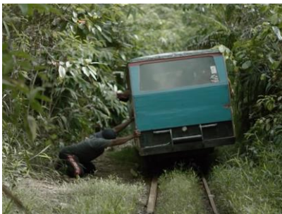
Gambar 7. Beberapa bagian rel yang rusak menyebabkan kenek lori harus membantu mengangkat lori untuk kembali ke jalurnya.
