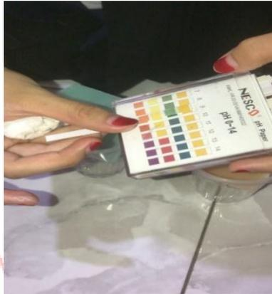
Gambar 3.7 Mengukur pH Asam Basa pada Sabun
