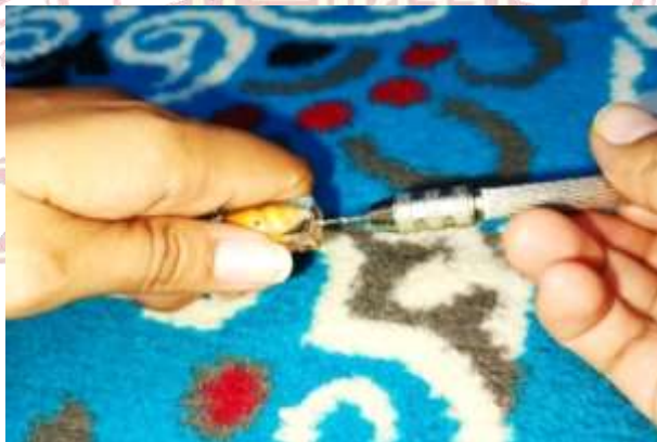
Gambar 3.5 proses pembuatan lobang pada resin
